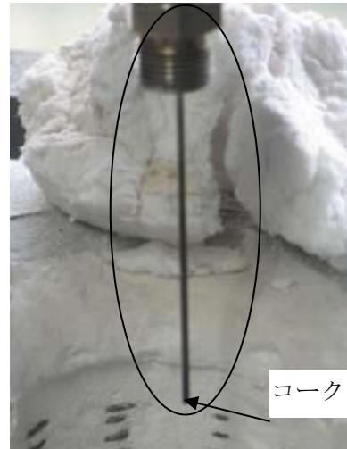
**図—9 供給管（コークが付着した状態）**
